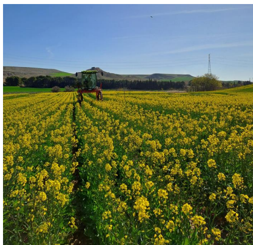
Castradora equipada con cuchillos cortando las líneas macho
